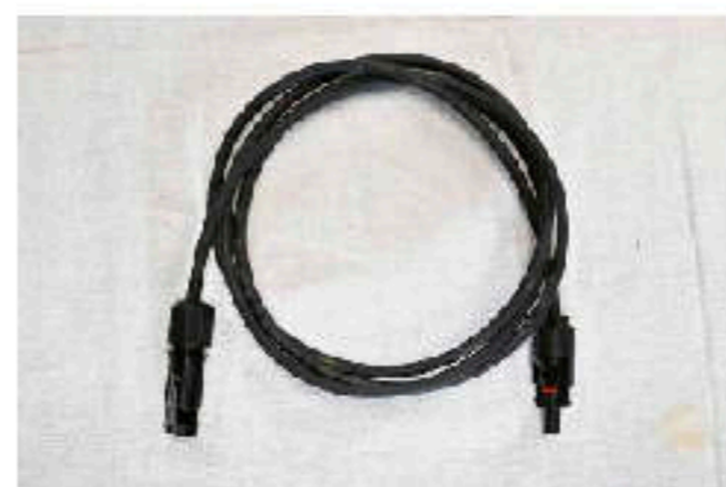
5.23: Hier das fertige Verlängerungskabel.
