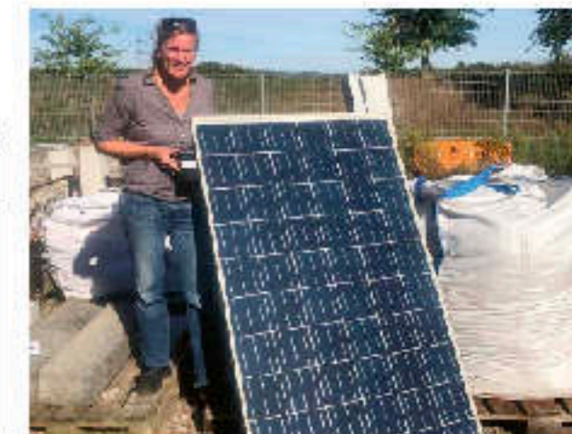
5.11: Mit dem Strahlungsmessgerät kann die Einstrahlung bestimmt werden, um den aktuellen Kurzschlussstrom des Moduls mit dem in der Kennlinie angegebenen zu vergleichen.
